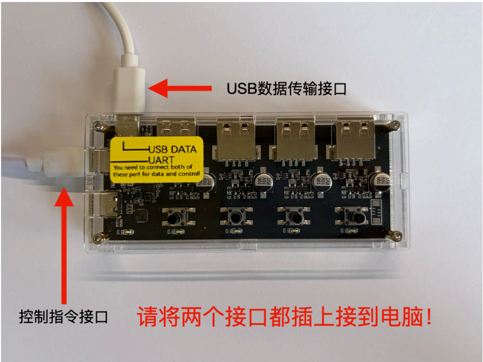
图 2：设备接线示意，CMD 与 DATA 接口都需要连接到 USB 主机。
